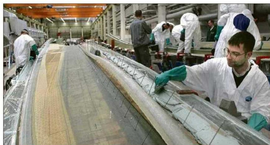
Enercon-Mitarbeiter bekleben im Rothenseer Werk den Rohbau eines Rotorblattes für eine Windkraftanlage.
